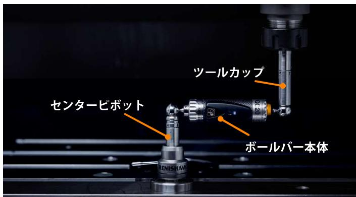
ボールバーテストは工作機械に円弧補間運動をさせるだけの簡単なテストです。これにより作業者による結果のバラつきは発生しません。
