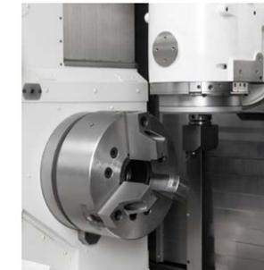
ワークの右端、左端のどちらを原点にするかをファンクションキーで指定するだけの簡単操作です。爪とワークの長さから原点オフセットを自動演算します。(刃物台の工具取付面を基準に工具オフセットを設定する場合)
