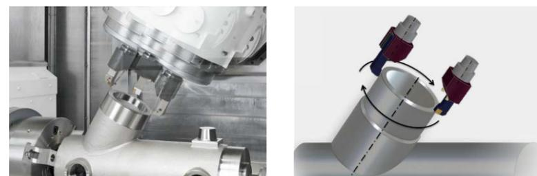
傾斜軸の旋削加工が可能
