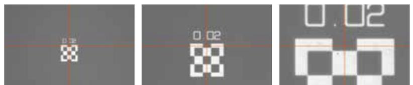
タレット1x 視野0.62×0.47 mm      タレット2x 視野0.31×0.23 mm      タレット6x 視野0.10×0.07 mm
