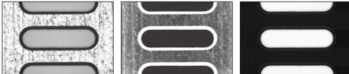
垂直落射照明      プログラム制御リング照明      透過照明
