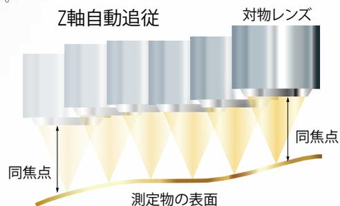
5 複数の断面画像により3D形状を測定
