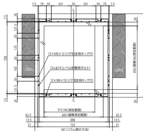
外観寸法図・測定テーブル寸法
