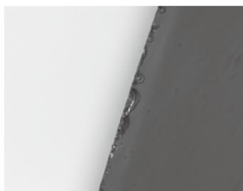
電子部品の印刷にじみ
