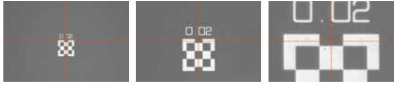
タレット1x 視野0.62×0.47 mm タレット2x 視野0.31×0.23 mm タレット6x 視野0.10×0.07 mm
