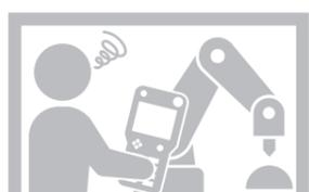
ティーチングペンダントを使い、目視で製品との干渉を確認しながら動きを調整します。熟練度による試行回数の差や、危険を伴います。
