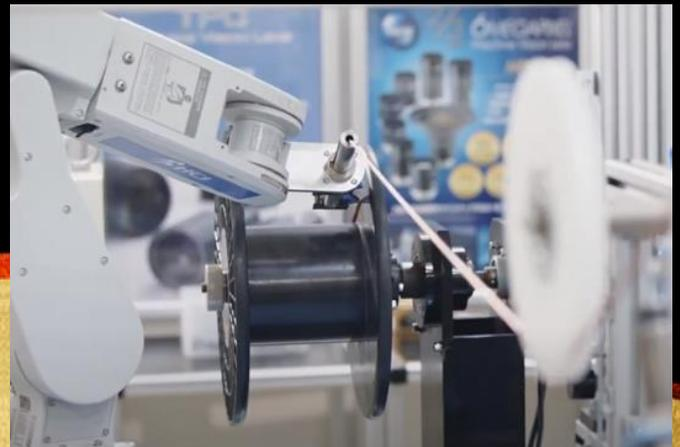
ロボットがケーブルを隙間なく
