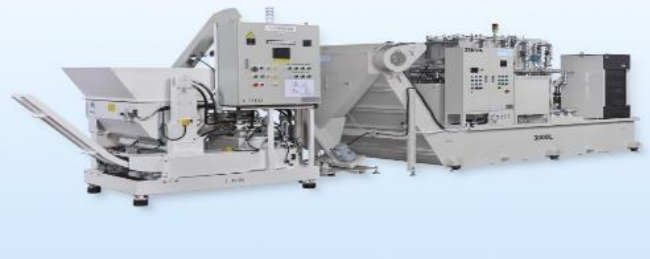
切粉圧縮機+集中ろ過装置
